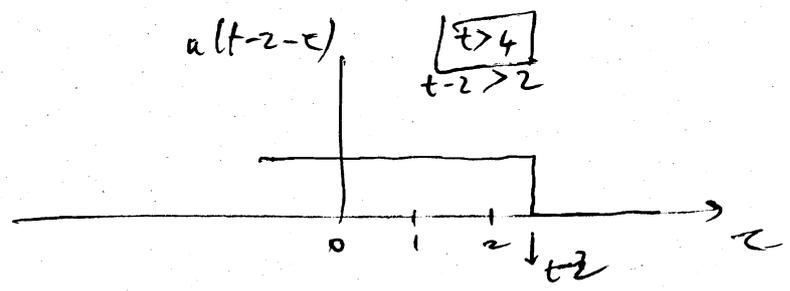
$$y(t) = \begin{cases} t < 1: \int_{-1}^{t-2} dc e^{-(t-2-c)} = 0 \\ 1 < t < 4: \int_{-1}^{t-2} dc e^{-(t-2-c)} = e^{-(t-2)} \left[ \frac{e^c}{1} \right]_{-1}^{t-2} = 1 - e^{-(t-1)} \\ t > 4: \int_{-1}^{t-2} dc e^{-(t-2-c)} - \int_2^{t-2} dc e^{-(t-2-c)} \\ = \int_{-1}^2 dc e^{-(t-2-c)} = e^{-(t-2)} \left[ e^c \right]_{-1}^2 \\ = e^{-(t-2)} [e^2 - e^{-1}] \\ = e^{-(t-4)} [1 - e^{-3}] \end{cases}$$
