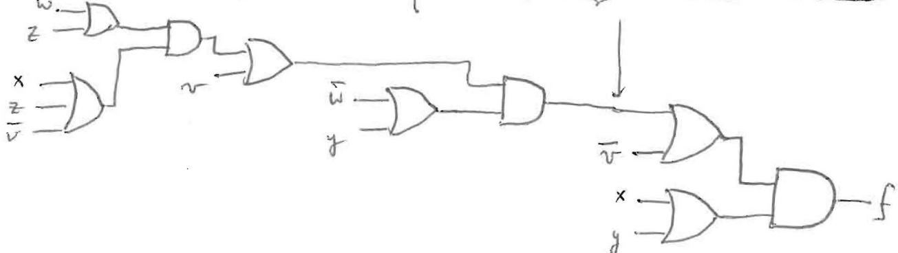
c)  $f(v, \bar{x}, y, z) = v \cdot \underbrace{[w \cdot (\bar{x} \cdot \bar{y} + \bar{z}) + \bar{x} \cdot z]}_{\text{with } \bar{v}, \bar{w}} + \bar{v} \cdot \bar{w}$
